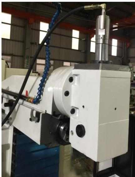
3. LSG-400D Защитная крышка для защиты горизонтального / вертикального шпинделя.
